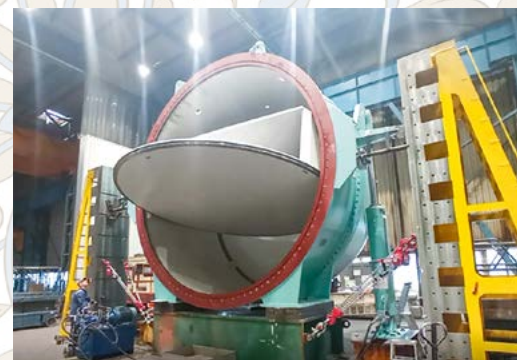
Válvula durante las pruebas de aceptación en fábrica, en el taller de ANDRITZ en Hungría
