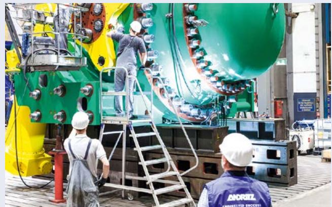
Prueba de presión y aceptación en fábrica de la primera de las seis válvulas esféricas para Dinorwig en presencia del cliente en otoño del 2022
