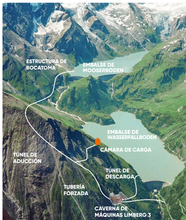
Esquema de Limberg 3, propiedad y operado por VERBUND
