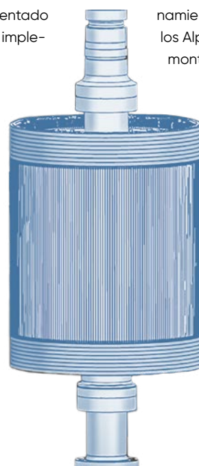
Vista 3D del rotor de Limberg 3
