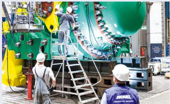
Essai de pression et réception en usine de la première des six vannes sphériques pour Dinorwig en présence du client, en automne 2022.
