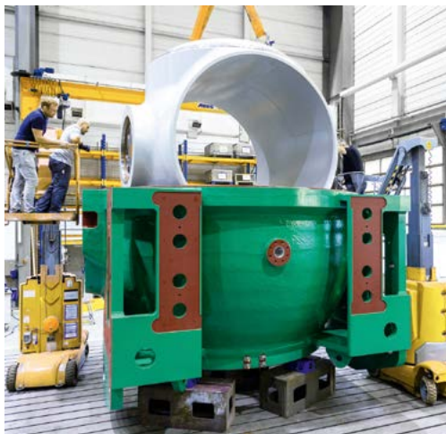
Сборка ротора в корпусе главного затвора
