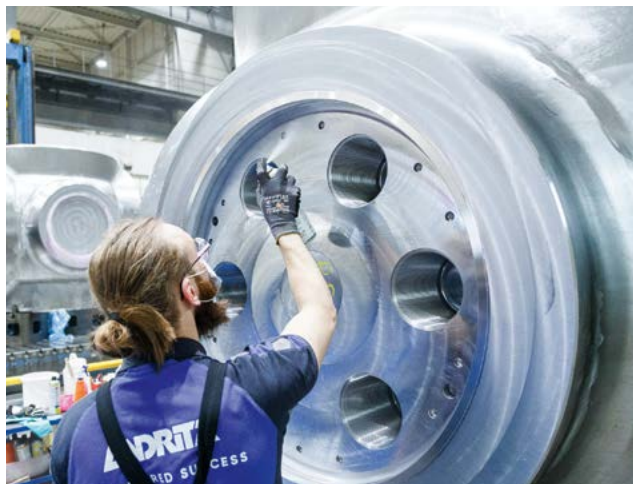
Проверка трещин на уплотнительных поверхностях ротора затвора
